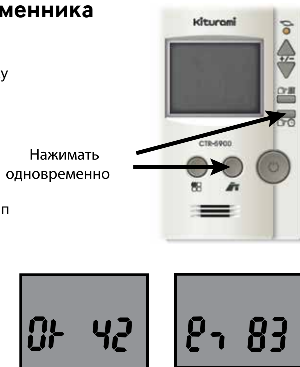
Рисунок 16. Настройка типа теплообменника
